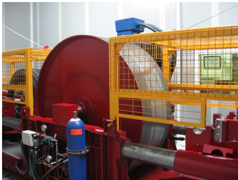
Figura 1. Instalación de ensayos de neumáticos disponible en la Universidad Miguel Hernández de Elche.
