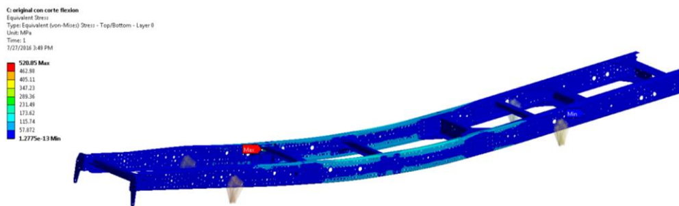
Imagen 2. Ejemplo de cálculo por elementos finitos de un bastidor de camión.
