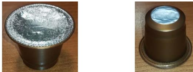
Figura 2. Vista superior (izq.) e inferior (der.) de un condensador (una cápsula de café) cuya capacidad puede medirse externamente por medios electrónicos para determinar el contenido en agua dentro de la misma
